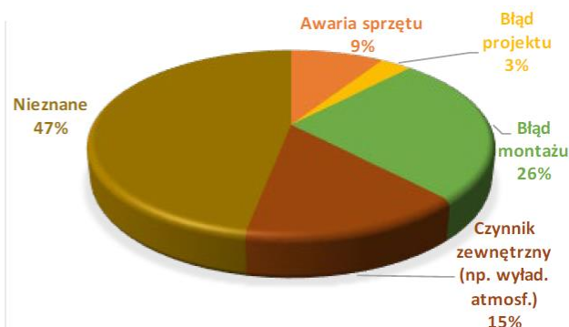
Rys. 4. Przyczyny wystąpienia pożaru instalacji PV w Wlk. Brytanii (dane z BRE 2017a)
